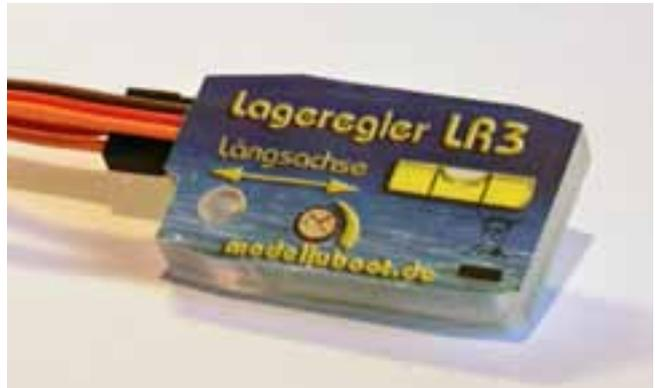
zurückgenommen. Bei Vollausschlag ist der Regler ganz abgeschaltet. Dadurch ist gewährleistet, daß der Steuermann bei Notmanövern immer die volle Kontrolle ausübt. Nur im kritischen Bereich um die Horizontale wird er vom automatischen Regler unterstützt.
