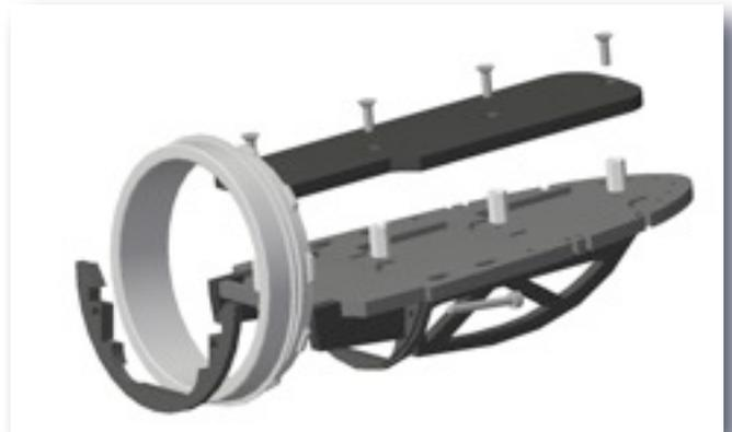
Der Einbaurahmen wird aus den Teilen 4.1 bis 4.3 zusammengeklebt.
