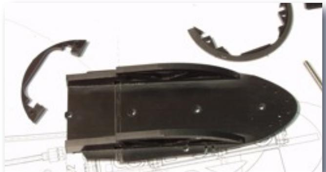
Der Spant 4.3 muss vorher noch passend schräg gefeilt werden. Das Standard-Deck ist für Graupner Servos der Baureihen C507, C577, DS8077, DES708 und DES807 ausgearbeitet. Für andere Abmessungen gibt es ein Alternativbauteil. Dabei muss allerdings noch für eine sichere Befestigung der Servos gesorgt werden.
