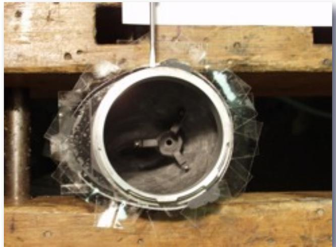
Da der Spalt recht groß sein kann, ist es sinnvoll, zunächst nur einige Stellen zu verkleben und später den gesamten Spalt von der Rückseite aus zu vergießen. Aber unbedingt Platz für den Halbspant lassen, der später den Einbaurahmen festhält.
