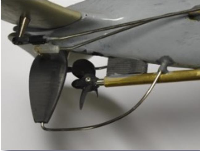
Die Achse ist der achtere Teil des Propellerschutzbügels. Der wird vorne von einem kleinen Rohrstück neben dem Stevenrohr gehalten. Achtern sitzt er in einer Bohrung im Rumpfe und wird von der Seite mit einer Madenschraube fixiert.
