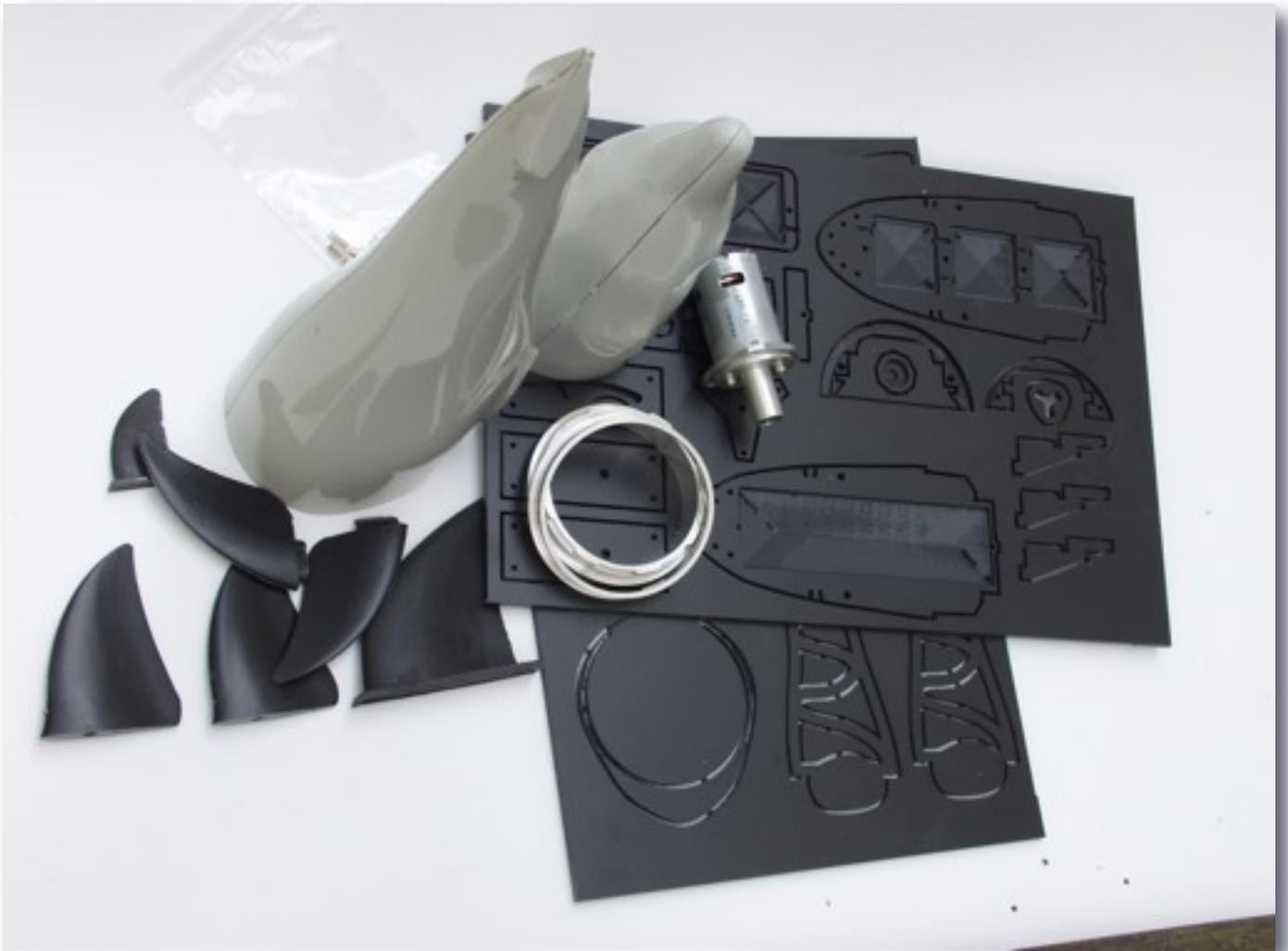
Der Rumpf besteht aus 2 Epoxi-Glasfaser Teilen.
